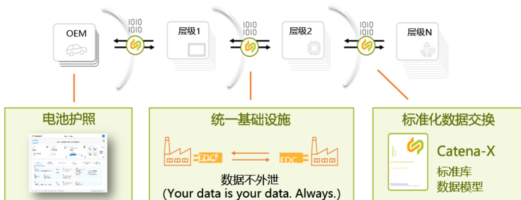
图67：作为电池的汽车制造商（OEM）和经济运营商，要颁发电池护照，需要在价值链中建立复杂的数字互动。每一层级上的所有供应商都受益于一个统一的基础设施，通过诸如Eclipse Dataspace Connector（EDC）这样的关键组件来保证数据主权。数据交换本身基于约定好的对齐的标准。除了图示层级之外，电池拆解商和回收商也获得了更多的商机。
