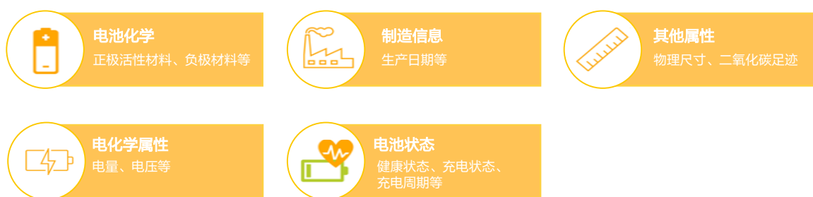
图66：电池护照可以看作是电池的数字孪生：它包含各种数据，包括电化学属性、有关电池化学的信息和制造信息或可持续性指标，如产品碳足迹。此外，还包括健康状态等动态参数，这些参数将在电池寿命期间更新。
