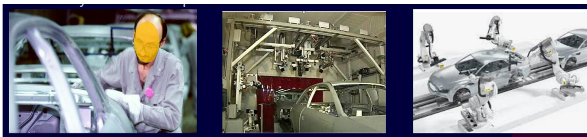
图8：自动车身检验系统“ABIS”从手工到机器人检验的演进
